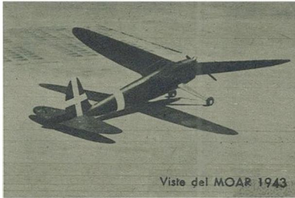
Alla fusoliera viene fissato il timone di direzione con longherone in compensato da mm 1,5, contorno in balsa 5x10 sagomato e alleggerito, centine in balsa da mm 1,5. Il pattino di coda, carenato, è ricavato da blocchetti di balsa alleggeriti internamente, il ruotino è ammortizzato da un filo d'acciaio di mm. 3.2 di diametro. Il carrello, profilato, è costruito tutto in balsa, e montato su due longheroni in filo
